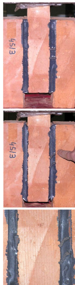
Rys. 8. Krzywe siła-przemieszczenie otrzymane podczas ścinania cegieł połączonych zaprawą (M) i polimerem (pm45) oraz widok testowanej próbki (postać zniszczenia) Fig. 8. Force-displacement curves obtained during shear tests of bricks joined with mortar (M) and with polymer (pm45) and also view of testing specimen (form of damage)
