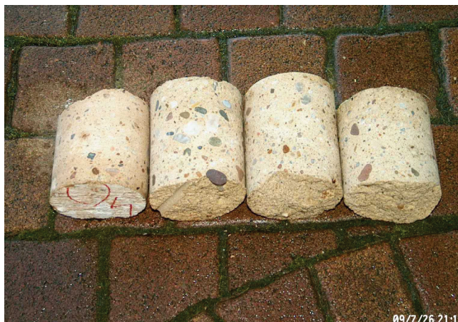
Rys. 8. Widok próbek rdzeniowych Fig. 8. View of core probes
