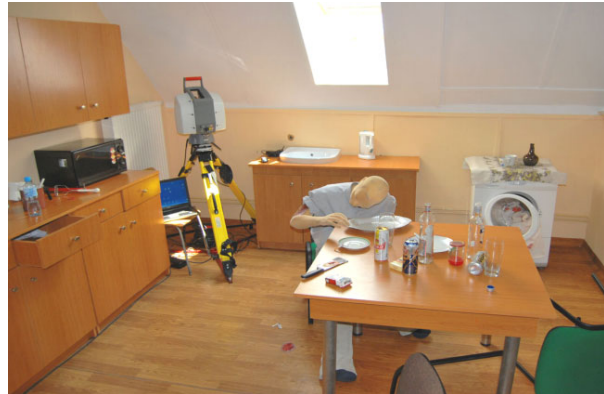
Rys. 1. Widok stanowiska z pracującym na miejscu zdarzenia skanerem 3D, fot. L. Koźmiński Fig. 1 The 3D scanner at the crime scene. fot. L. Koźmiński
