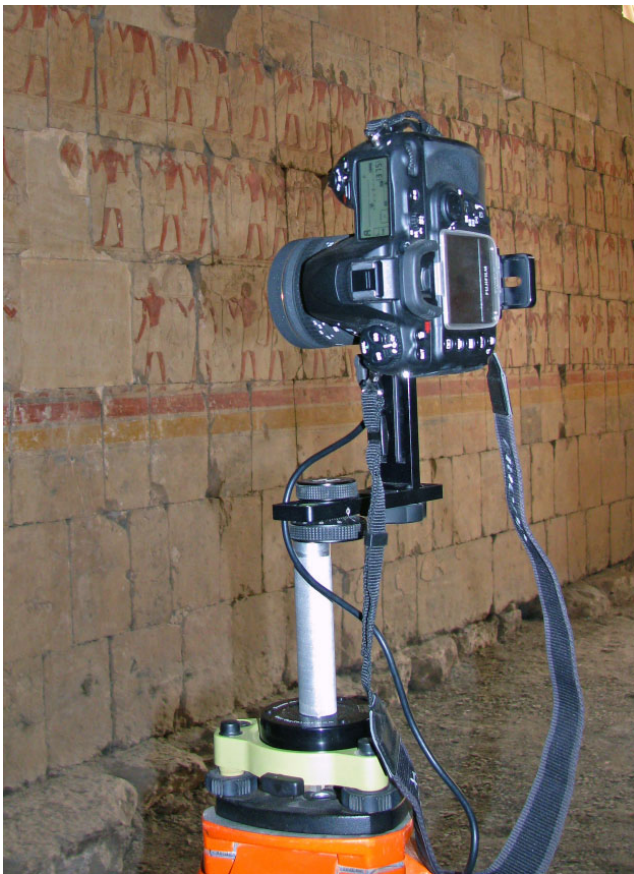
Rys. 2. Kamera FujiFilm S5 Pro ustawiona na spodarce za pomocą przystawki Nodal Nina Fig. 2. FujiFilm S5 Pro mounted on tribrach with the Nodal Ninja bracket
