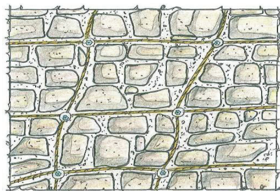
Fig. 2. A typical continuous mesh Rys. 2. Typowa siatka ciągła
