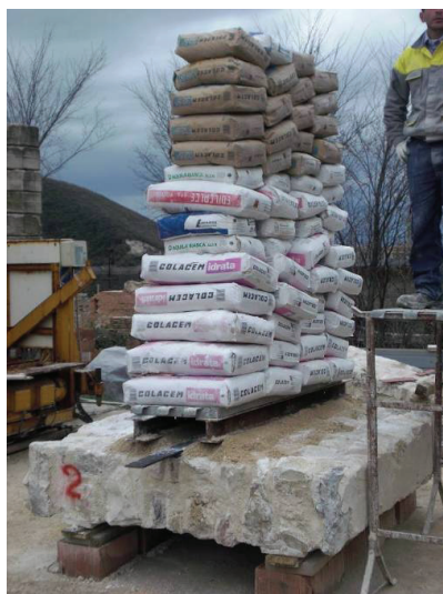
Fig. 9. Testing of panel 2 Rys. 9. Próba zginania płyty 2
