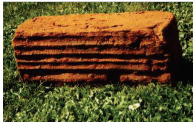
Rys. 6. Gotycka cegła palcówka, ze zbiorów ASP Kraków, fot. I. Płuska Fig. 6. Gothic brick with a frog made with fingers (Pol. palcówka) Collection of the ASP Krakow; photo I. Płuska
