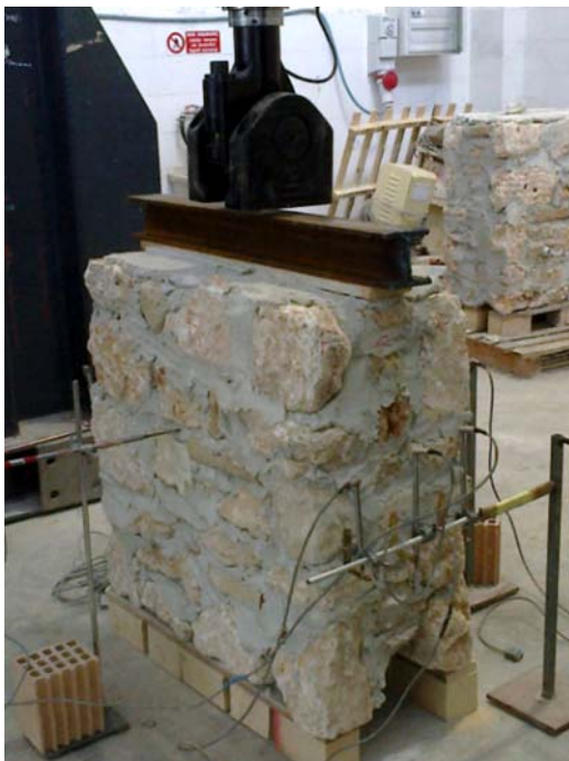
Ryc. 6. Laboratorium w Terni, Uniwersytet w Perugii. Sposób realizacji stanowiska badawczego w próbie ścinania
