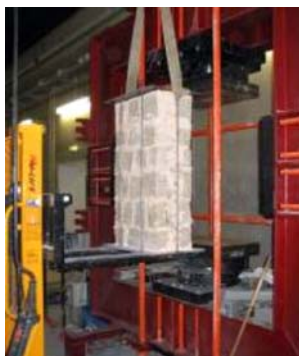
Ryc. 3. Stanowisko do ściskania prostego w laboratorium [4]
