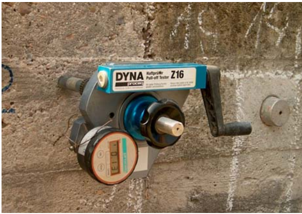
Ryc. 5. Widok urządzenia DYNA w czasie pomiarów Fig. 5 DYNA system during measurements
