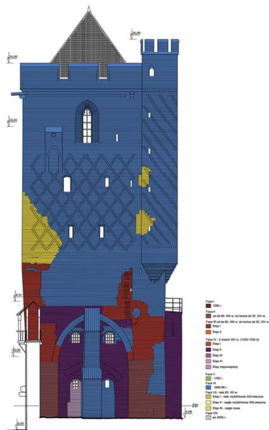
Ryc. 3. Wieża Klesza na Zamku Wysokim w Malborku. Elewacja północna, rozwarstwienie chronologiczne (oprac. M. Prarat) Fig. 3. The Klesza Tower in the High Castle in Malbork. North elevation, chronological stratification (auth. M. Prarat)
