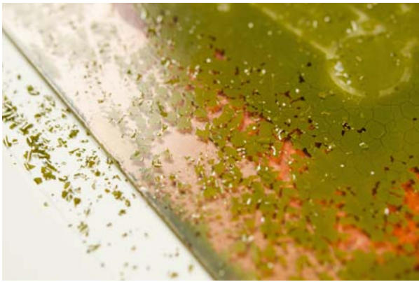
Ryc. 7. Detal negatywu kolodionowego, widoczne uszkodzenia warstwy obrazu, odspojenia i wykruszenia
