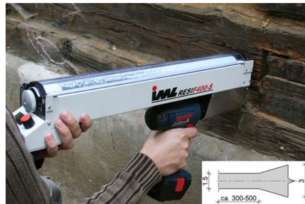
Ryc. 11. Urządzenie do pomiaru oporu wiercenia. Kształt i wymiary wiertła w [mm] pokazano w prawym dolnym rogu Fig. 11. Resistance drilling device during testing. Drill shape and dimensions in mm are shown in the lower right corner
