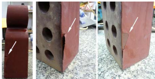
Ryc. 8. Próbką 1.1A po badaniach mrozoodporności – przykład uszkodzenia
