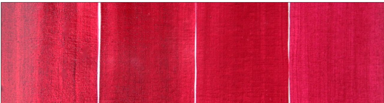
Ryc. 6. Efekt dodania do karminu sproszkowanego szkła w trzech różnych proporcjach.
