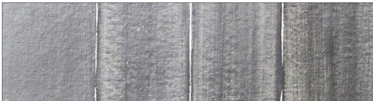
Ryc. 8. Efekt dodania do bizmutu sproszkowanego szkła w trzech różnych proporcjach. Fig. 8. The effects of adding powdered glass to bismuth in three different proportions.
