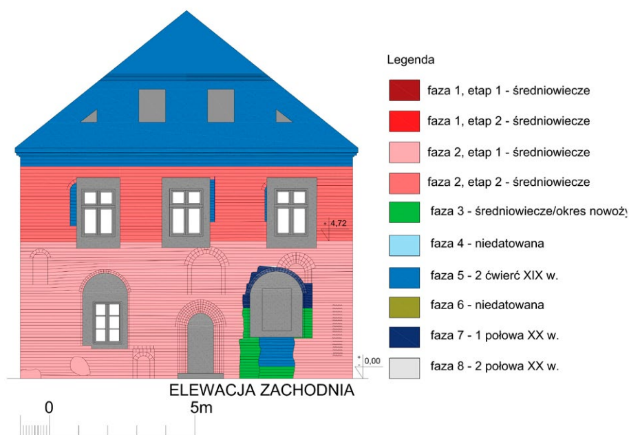
Ryc. 10. Kalisz, dawny klasztor kanoników laterańskich; elewacja zachodnia, rozwarstwienie chronologiczne; oprac. M. Prarat. Fig. 10. Kalisz, former monastery of the Lateran canons; western facade, chronological stratification; by M. Prarat.
