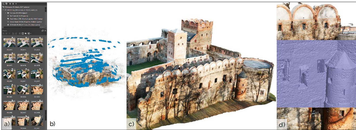
Ryc. 3. Ząbkowice Śląskie – odwzorowanie fotogrametryczne; a) zestaw 804 zdjęć z drona wykonany przez poinstruowany zespół studentów, czas prac terenowych ok. 4 godzin; b) koordynacyjna chmura punktów – obliczenia pozycjonujące ok. 6 godzin; c) uzyskany model siatkowy, czas obliczeń ok. 16 godzin, obszar 100x100 m; d) fragment jakościowego odwzorowania tekstur i geometrii; oprac. autor.
