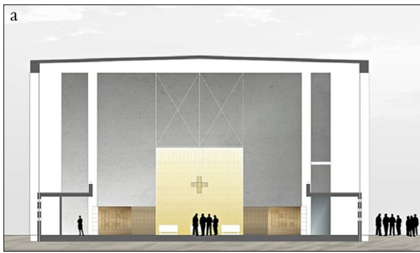
Ryc. 1. Kolumbarium w kościele św. Bartłomieja w Kolonii, 2014; a) przekrój, b) rzut, c) widok na miejsce na urny; źródło: https://www.kissler-effgen.de/gebaut/#portfolio-item-example-110 .
